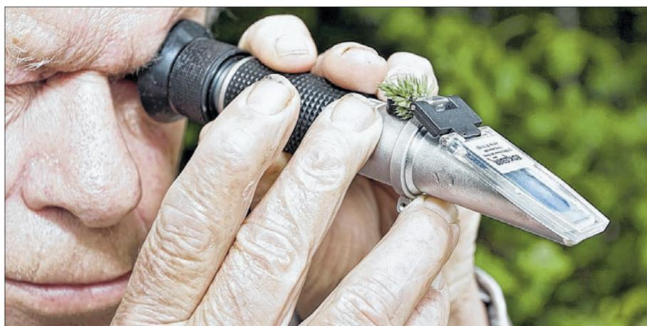
Mit dem Refraktometer überprüft Siegfried Nagel den Wassergehalt des Honigs noch vor der Ernte am Bienenstock.
